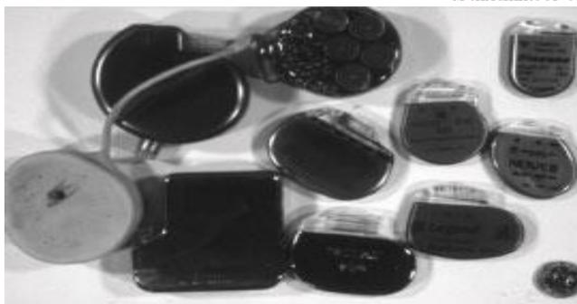
**Fig 2 : Évolution de la forme et du volume des stimulateurs cardiaques, avec la réduction spectaculaire de la taille des appareils due à la miniaturisation des circuits et des piles.**
